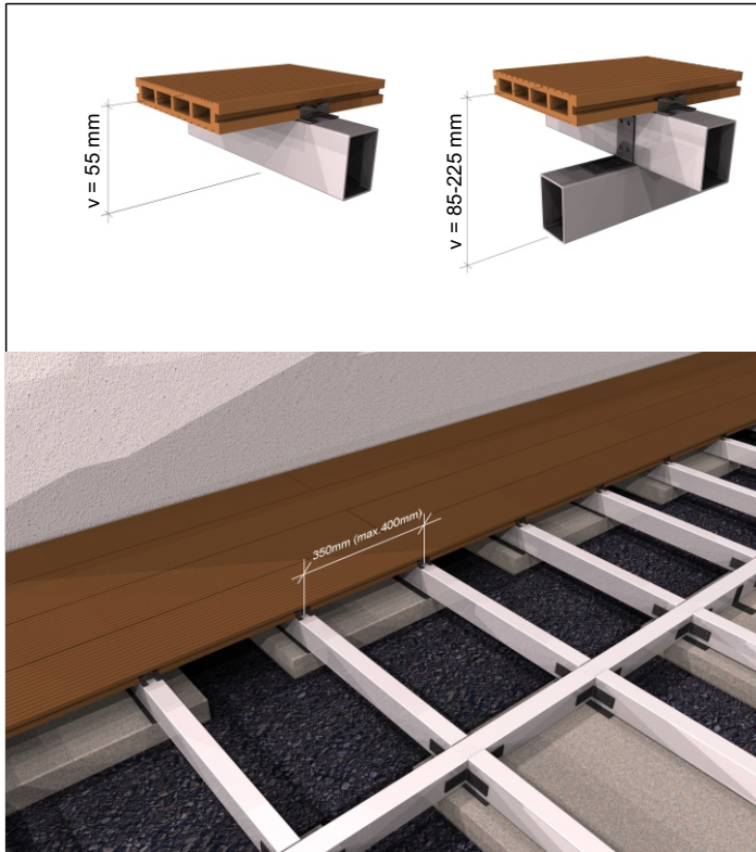
SKLADBA TERASY NA AL ROŠTE - podklad zhutnený makadam
